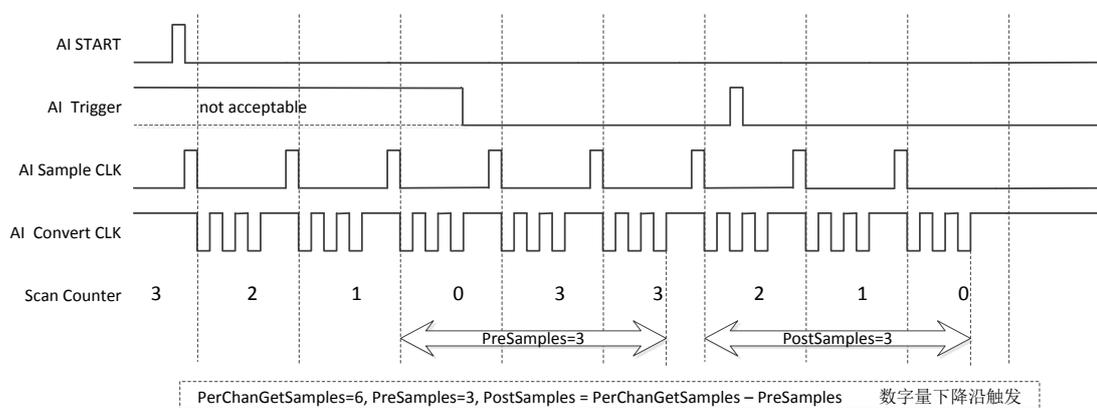
图 4-6 中间触发触发点分割数据
