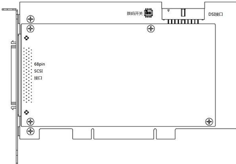
图 2-1 PCIe-6266 产品布局图
