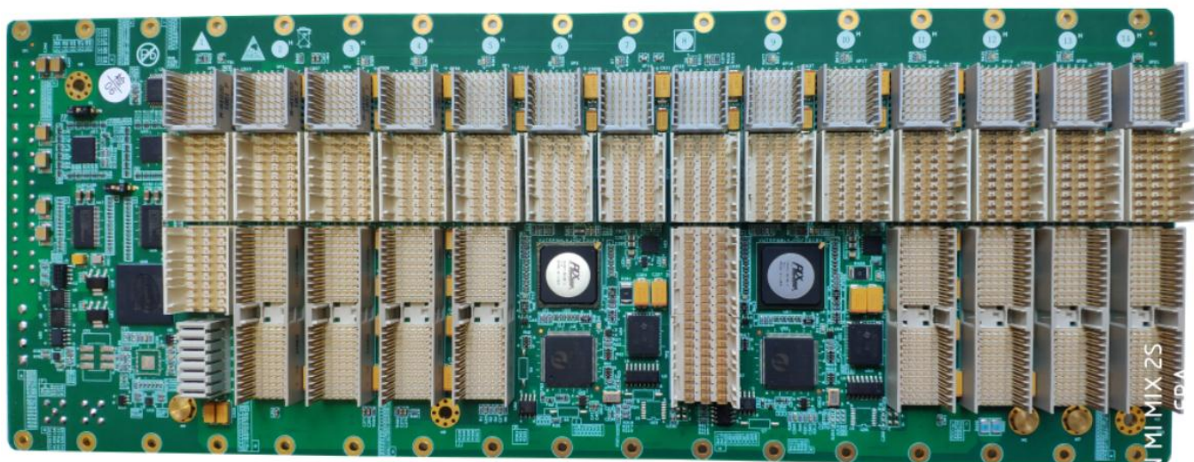
图 1-3 14 槽 PXI 背板前视图
